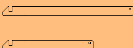
Cariglione L=500mm Cariglione L=676mm Lunghezze speciali su richiesta. Door/isolator interlock - L=500mm - L=676mm Special length on request
